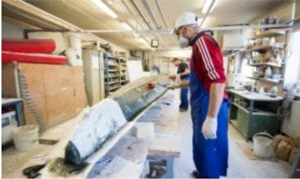
Abb.: 17 Laminieren ist und bleibt Handarbeit, das rechtfertigt auch den höheren Preis (Foto Globetrotter)
