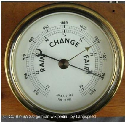
Abb.: 58 Dosenbarometer zur mechanischen Messung des Luftdrucks.
